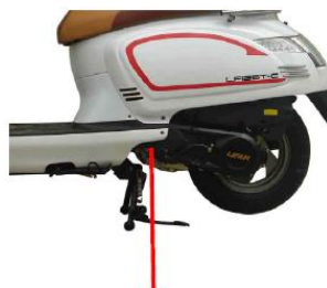
Fig. 5 Código del motor
